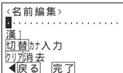
2 **代理応答/切替** ボタンを押し、漢字入力モードに切り替える
